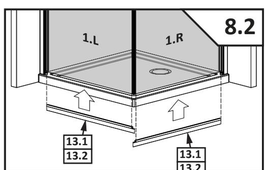
Montage mit Schwallschutzleiste
