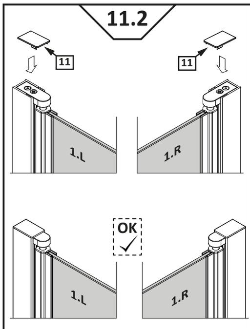
Montage mit Schwallenschutzleiste
